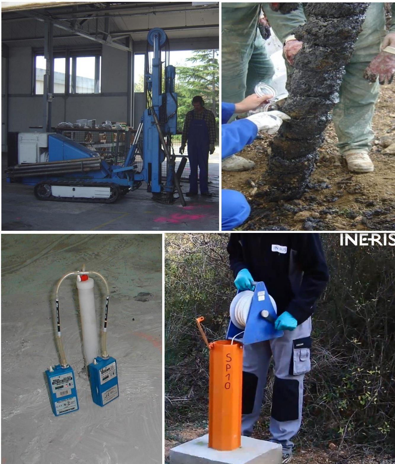
Investigations de terrain : (a) carottage mécanique, (b) prélèvement à la tarière mécanique, (c) échantillonnage de gaz du sol, (d) mesure du niveau piézométrique (profondeur des eaux souterraines)
